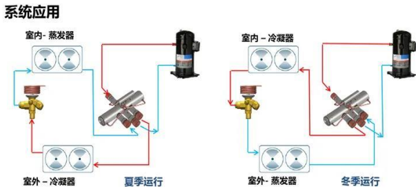
图26: 不锈钢四通阀助力整机能效提升约1%
