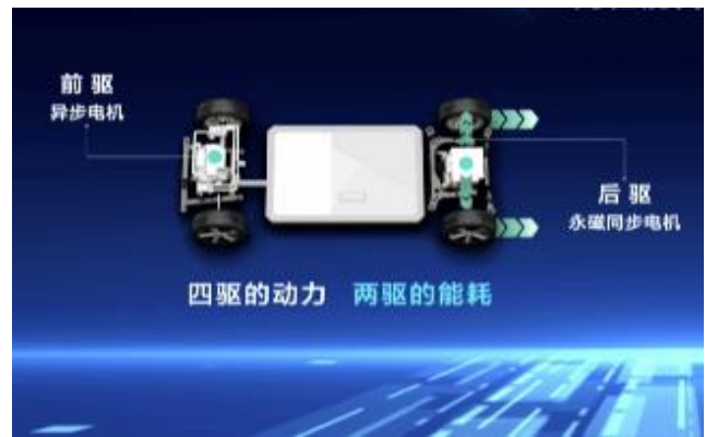
图 25：高性能四驱架构
