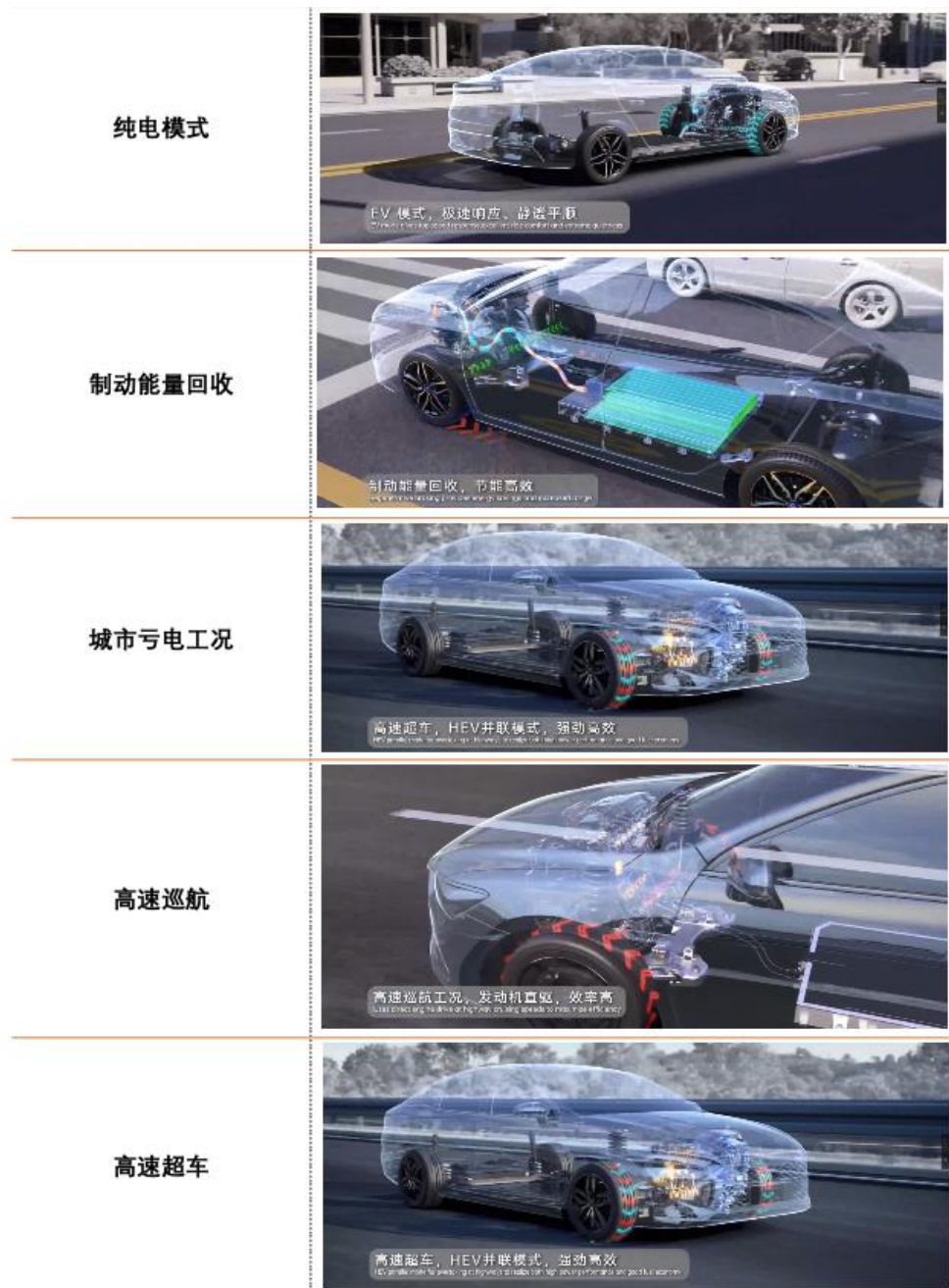
图 47：DM-i 超级混动系统在不同工况下的驱动模式
