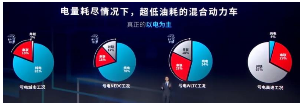
图 48：DM-i 超级混动系统在不同工况下的驱动模式
