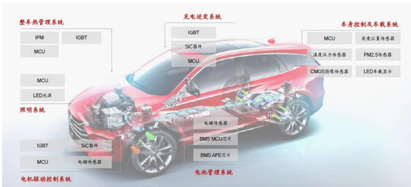
图 82：比亚迪半导体的车规级半导体产品在新能源汽车中的应用
