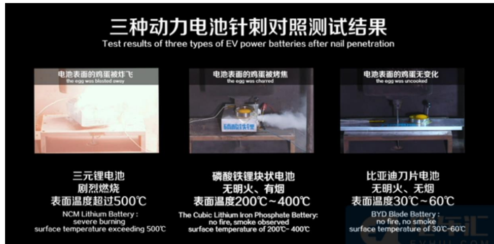
图 80：刀片电池针刺测试结果
