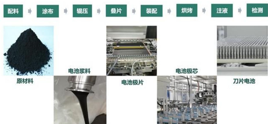
图 81：刀片电池的八大生产工艺
