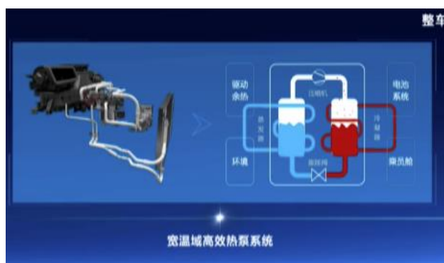
图 26：高温域高效热泵系统
