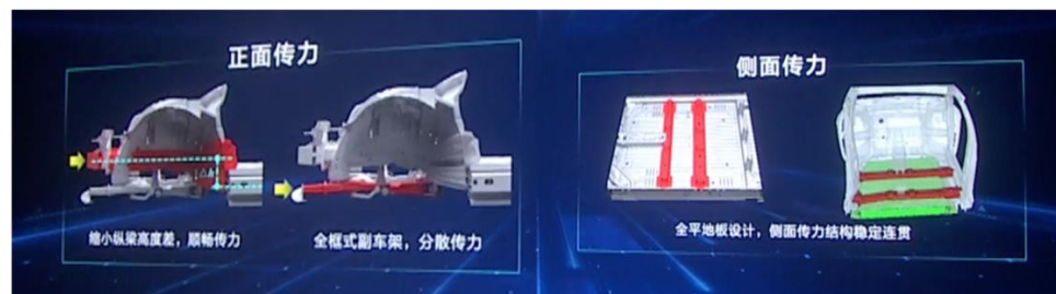
图 23：e3.0 平台打造纯电平台专属传力结构
