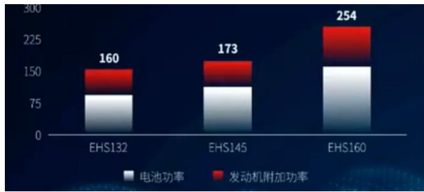
图 53：DM-i 混动系统综合效率（单位：kW）
