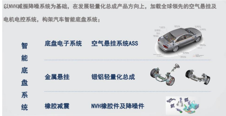
图表 49：公司智能底盘系统构成
