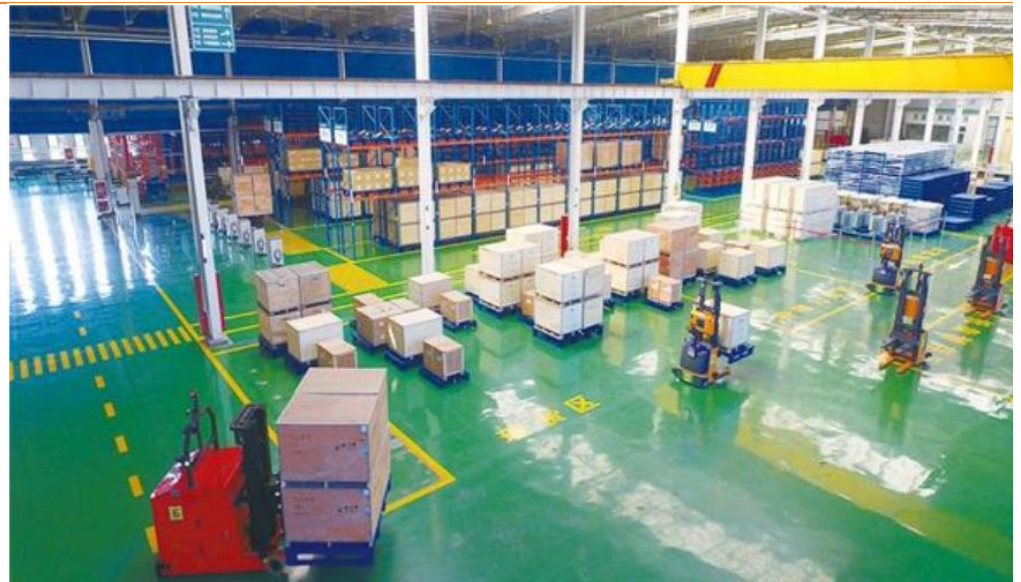
图 16: 公司托盘无人导引车 AGV 系统应用场景
