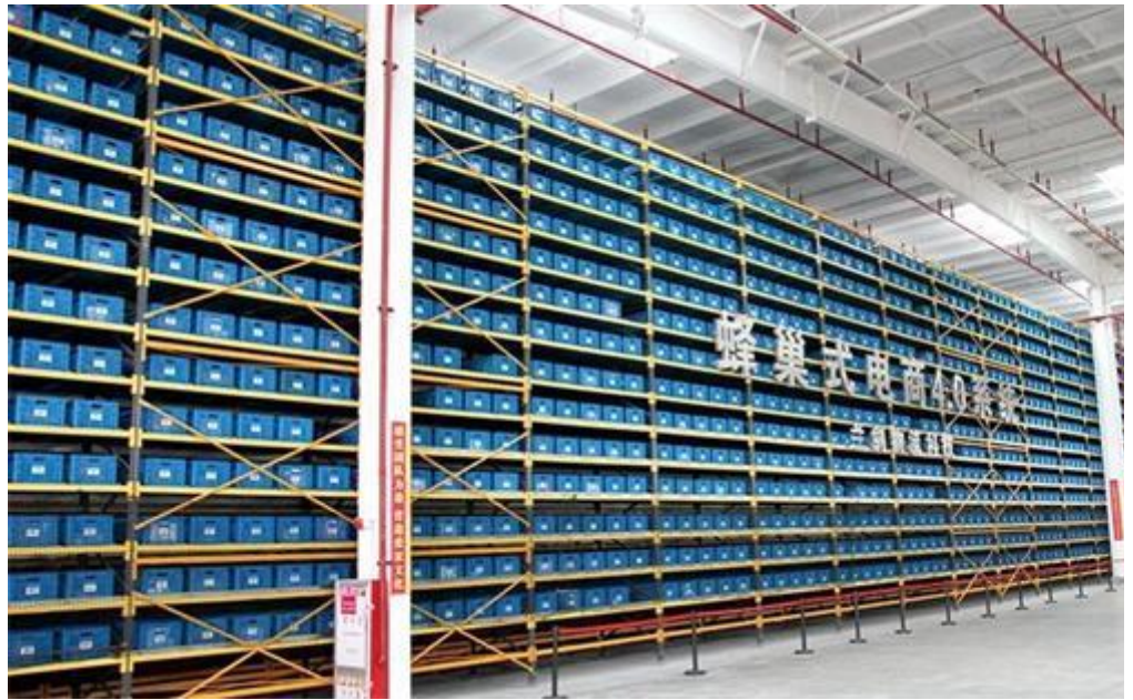
图 8：公司料箱级密集仓储拣选（立体货到人）一体化系统
