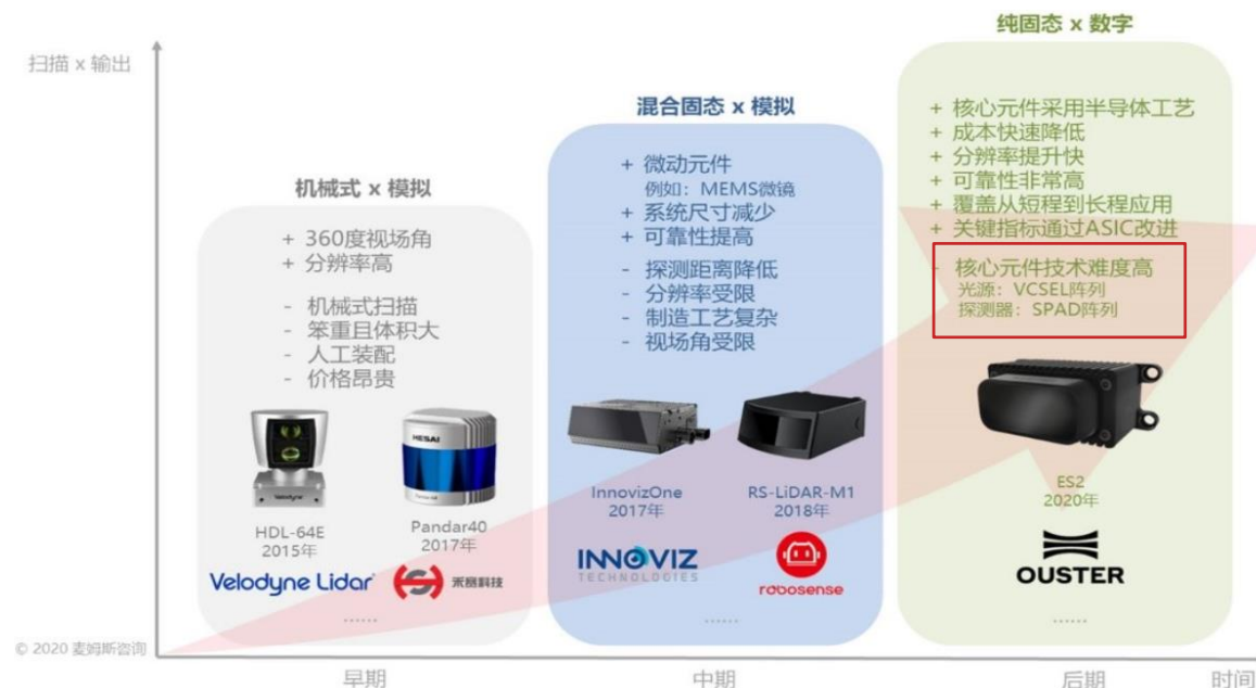
图63 汽车激光雷达发展线路图：“模拟、机械式”到“数字、固态化”
