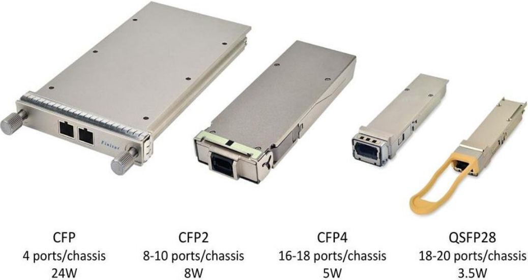
图20 光模块封装越来越小，功耗越来越低
