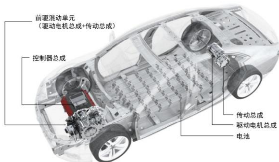
图28：电驱动系统在电动车的安装位置
