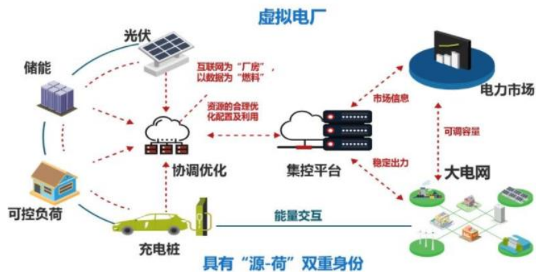
图 35：虚拟电厂示意图
