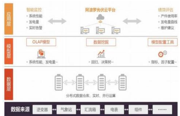
图 28：远景能源的“阿波罗”光伏云平台示意图
