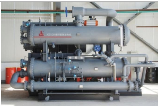
图 55：开山 ORC 螺杆膨胀机
