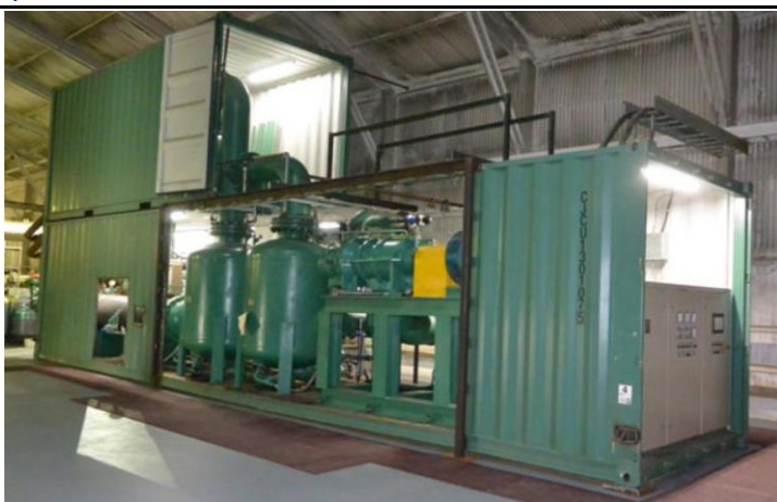
图 39：单级 ORC 膨胀发电机组
