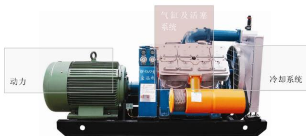
图 3：活塞压缩机结构
