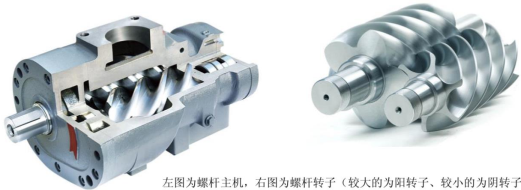
图 14: 螺杆主机结构图
