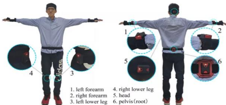
图 15：6 个惯性传感器的位置（左、右前臂、左、右小腿、头部和骨盆）
