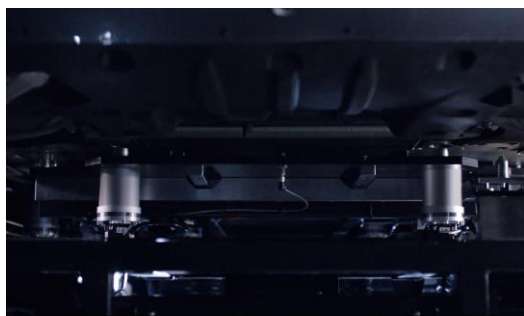
图表 21: 蔚来底盘换电示意图
