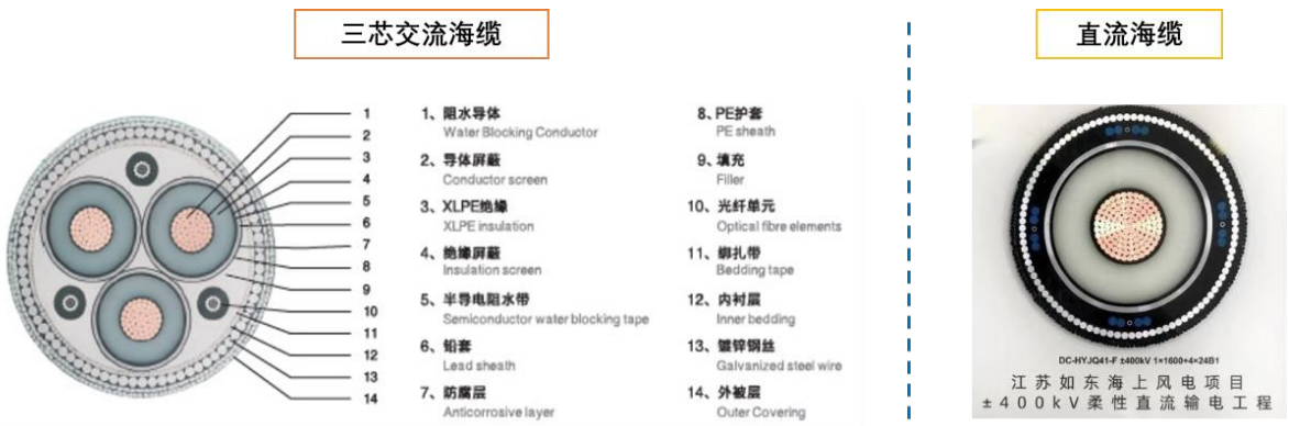
图表21 三芯交流海缆和直流海缆结构示意图
