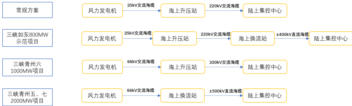
图表 25 海上风电项目海缆技术的演进趋势示意图
