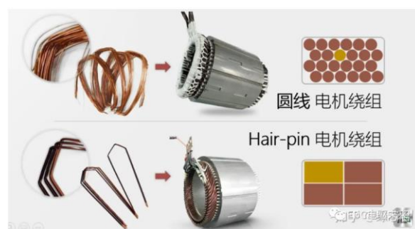
图16：Hair-pin 绕组方式更高的槽满率
