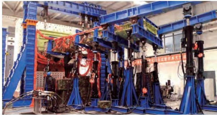
图29：C919复合材料机翼研制攻关项目典型盒段静力和损伤容限试验
