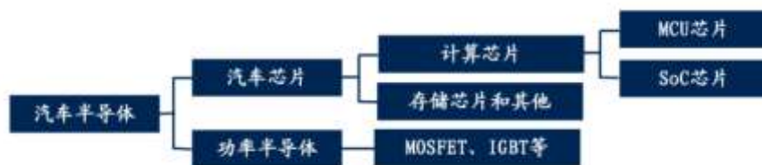
图 11：汽车半导体分类结构
