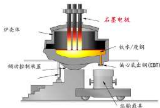
图 17: 石墨电极在电弧炉中的应用
