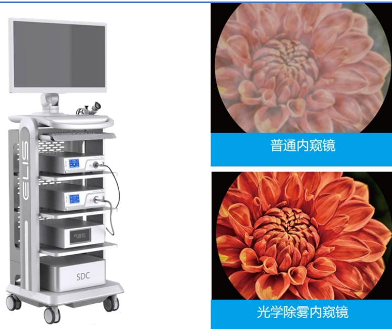
图 20：高清除雾内窥镜设备及显示效果
