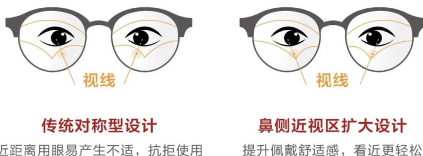
图 18: 明月“轻松控”近视防控镜片向鼻侧内偏设计示意图
