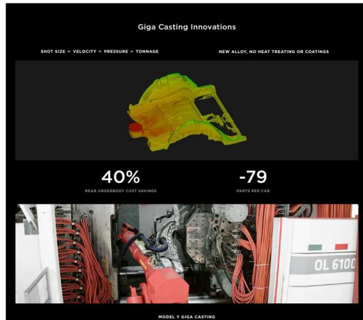
图：一体式压铸下车体
