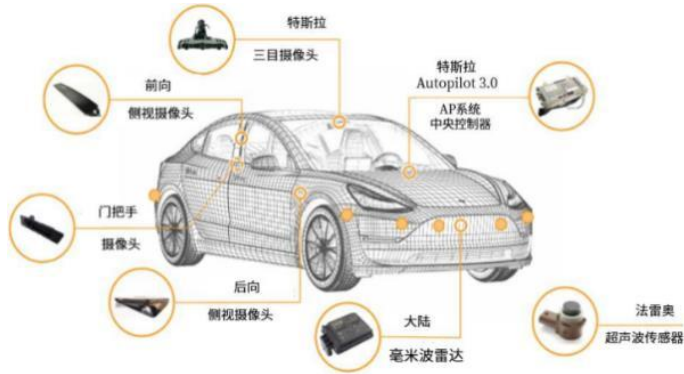
图 22：特斯拉 Model 3 传感器分布
