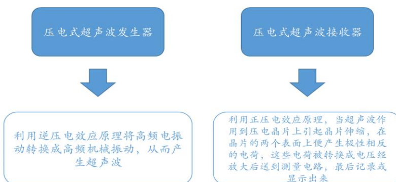
图 10：压电式超声波工作原理
