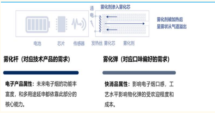
图表 7：雾化电子烟工作原理
