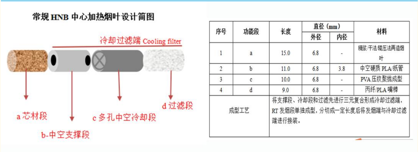
图表 19: 常规 HNB 中心加热烟叶设计图
