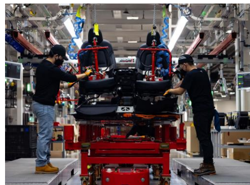
图 12：德州工厂中座椅与 4680 CTC (Structural Battery) 电池包直接连接
