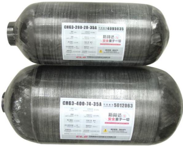
图 15：车用氢气铝合金内胆碳纤维全缠绕气瓶
