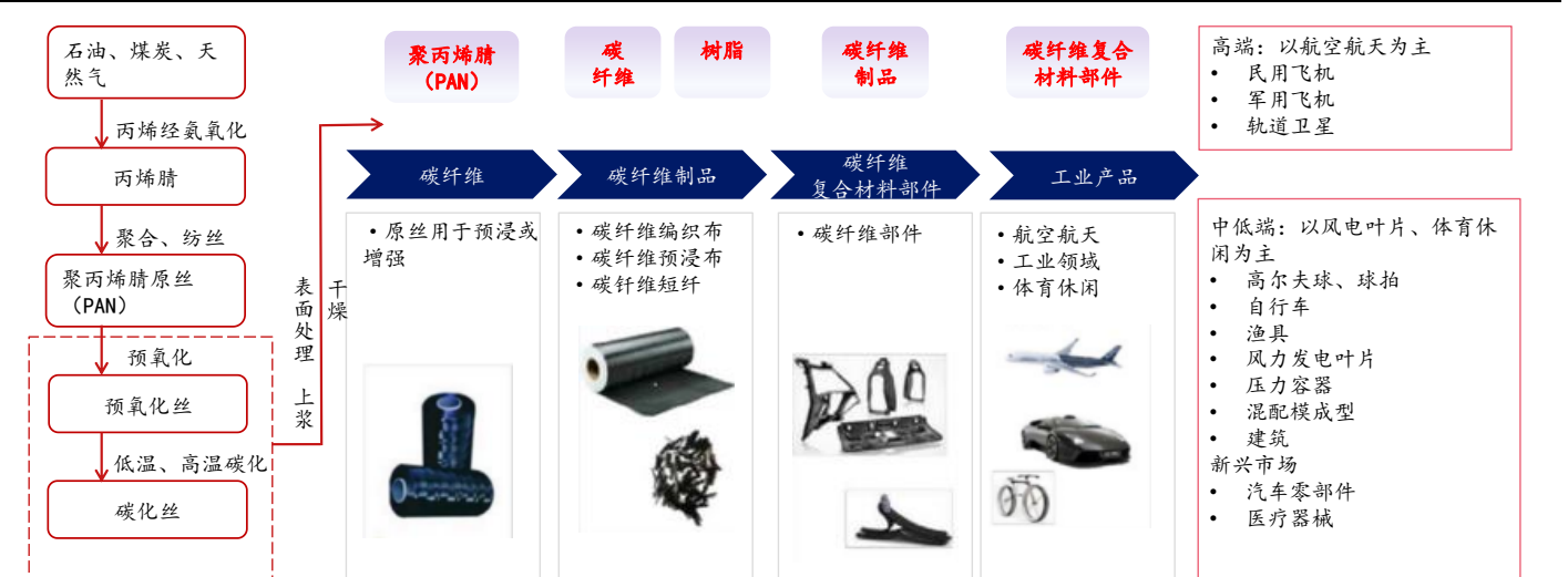
图15: 碳纤维原丝及碳纤维复合材料均是产业链上重要的两个环节
