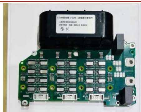
图 48 采用安世 GaN 功率组件的新能源车电机控制器
