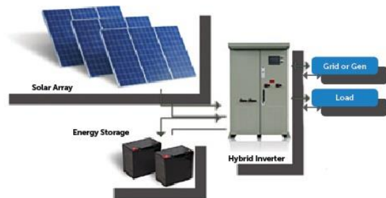
图：光储混合逆变器同时具备并网逆变器和储能逆变器功能
