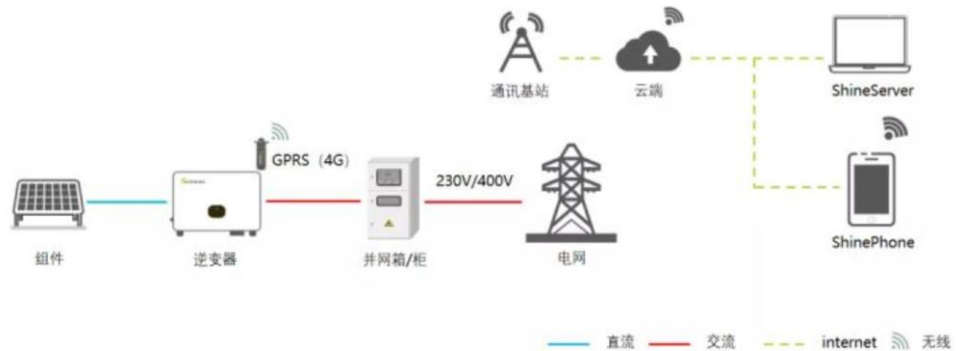
图 37：光伏逆变器 GPRS/4G 通信方式
