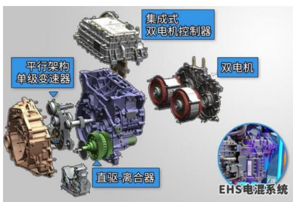
图表18 比亚迪DM-i EHS电混系统
