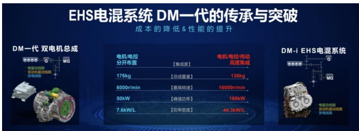
图表16 比亚迪 DMI 电混系统较第一代 DM 性能显著提升、成本降低
