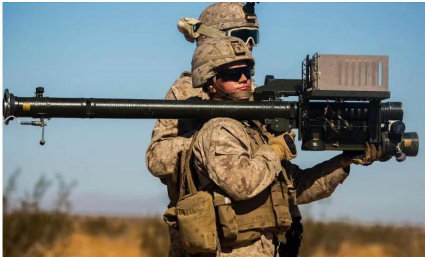
图 6 发射筒上方形似方型的金属框即为敌我识别器天线
