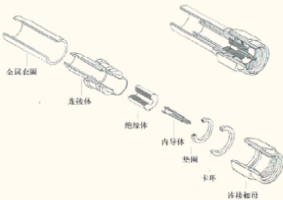
图表 28: 射频同轴连接器的基本结构
