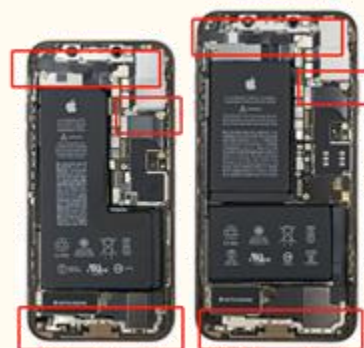
图表 42: iPhone XS/XS Max 搭载 3 组 LCP 天线
