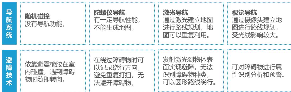
部分产品采用激光导航和视觉避障使性能优化
