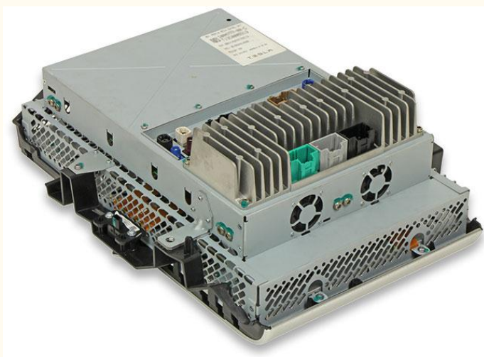
图表 45：特斯拉 MCU1（功放集成在背面）
