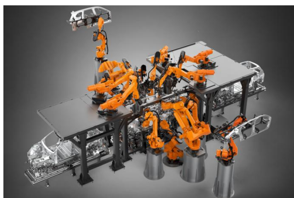
图3：白车身智能连接生产线
