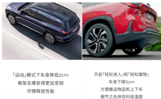
图表 4: 蔚来 ES8 空气悬架的车身高度调节
