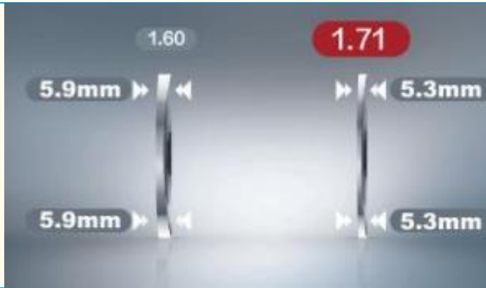
图表 31: 1.60、1.71 折射率非球面树脂镜片比较
