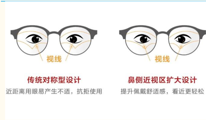
图表 27: 明月镜片鼻侧内偏设计
