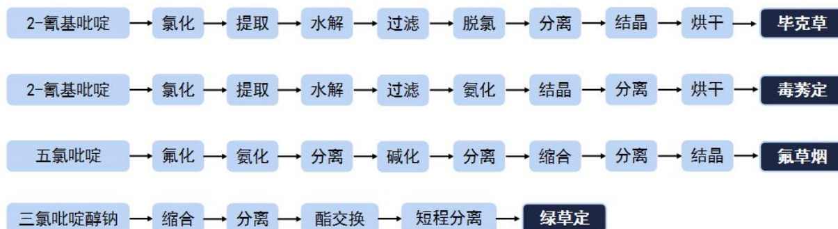
图21：利尔化学氯代吡啶类除草剂生产流程
