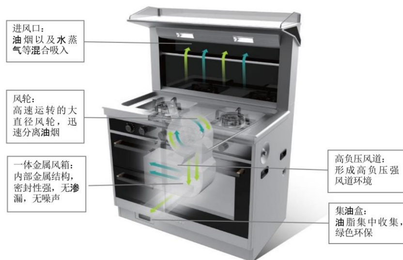
图 21：帅丰电器集成灶产品结构示意图
