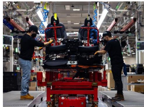
图 21：德州工厂中座椅与 4680 CTC (Structural Battery) 电池包直接连接
