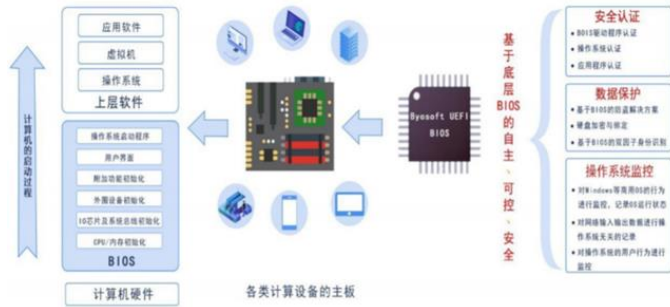
图18: BIOS 固件是一组固化到计算设备主板上一个存储芯片中的系统程序
