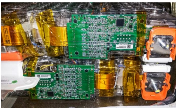
图16: Model S 电池组中的 BMS
