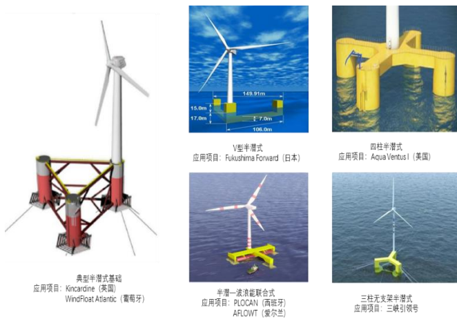
图表10 典型半潜式基础以及其他新型的半潜式基础
