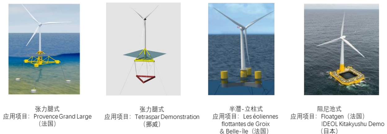
图表12 新型张力腿式基础及其他新型基础示意图
