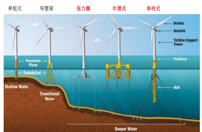
图表7 适应不同水深的海上风电基础结构示意图
