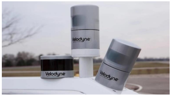
图10：机械式激光雷达需要搭载于车顶高速旋转
