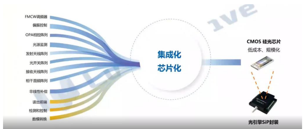
图22: OPA 方式将多种光学元件集成于一身
