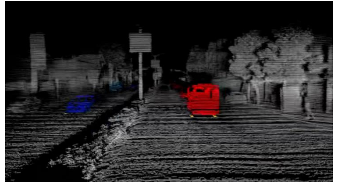
图8: FMCW 激光雷达能提供速度信息
