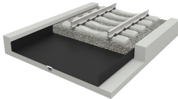
图 4 橡胶减振垫应用图解
