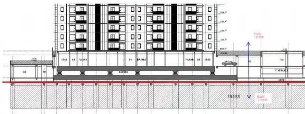
图 37 万科徐泾地铁上盖减隔震设计示意图
