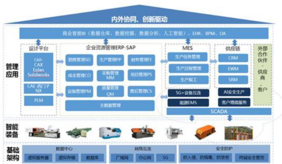
图表 11 公司数字信息化工厂架构
