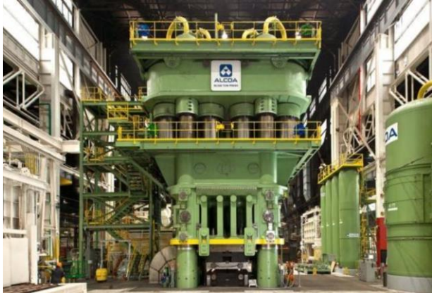
图表 18: 美国铝业翻新 4.5 万吨模锻水压机承接 F-35 订单
