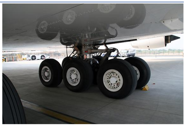
图表 17: A380 主起锻件是世界最重的航空钛合金模锻件
