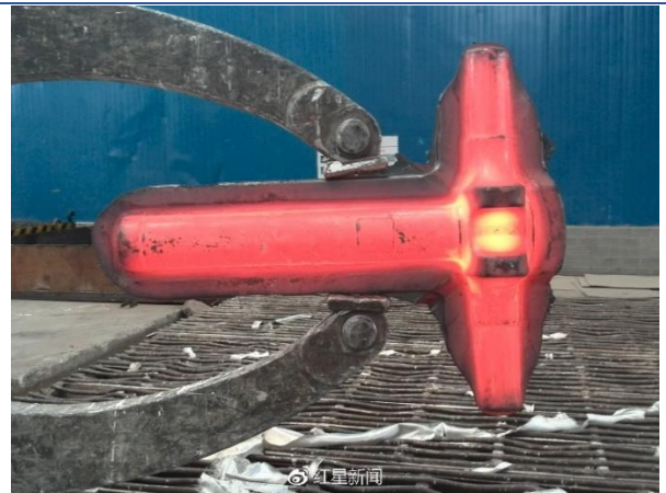
图表 23: 二重万航 8 万吨锻压机锻造 C919 主起活塞杆
