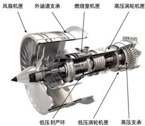
图表 47: 锻造件在航空发动机中的应用部位
