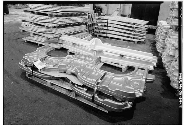
图表 19: F-15 战斗机后机身发动机段隔舱框架的钛合金胚料
