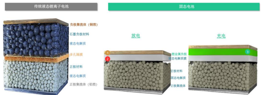
图 13：传统液态锂电池与固态电池示意图
