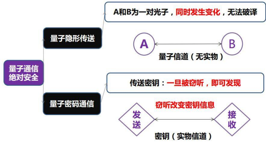
图 13：量子通信绝对安全原理
