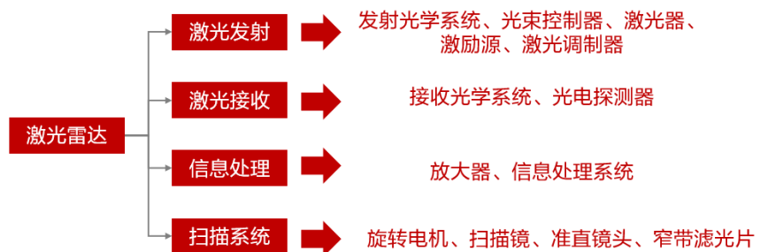
图 10：激光雷达的基本零部件组成
