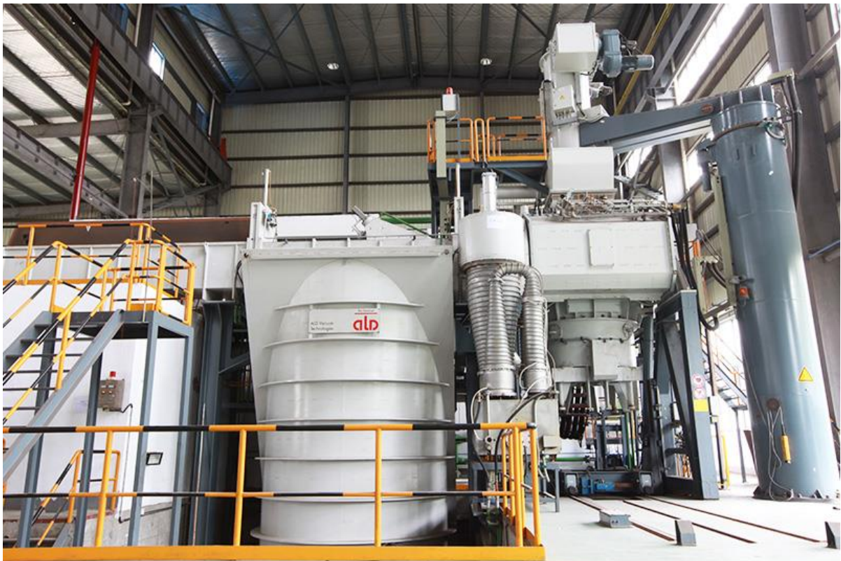
图表 124 图南股份 8000KG 真空感应炉
