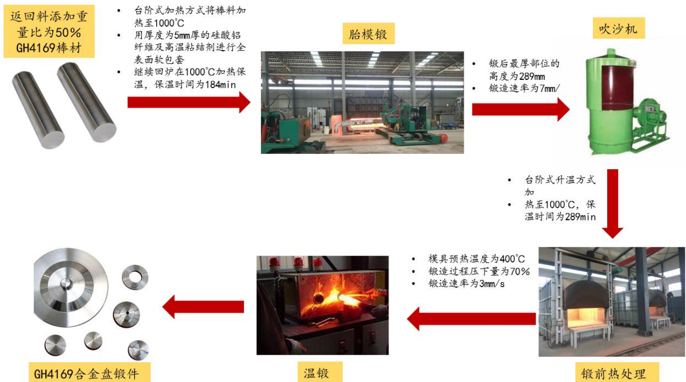
图表 45 专利 CN111761007A 对高返回料添加 GH4169 合金盘锻件制造示意图
