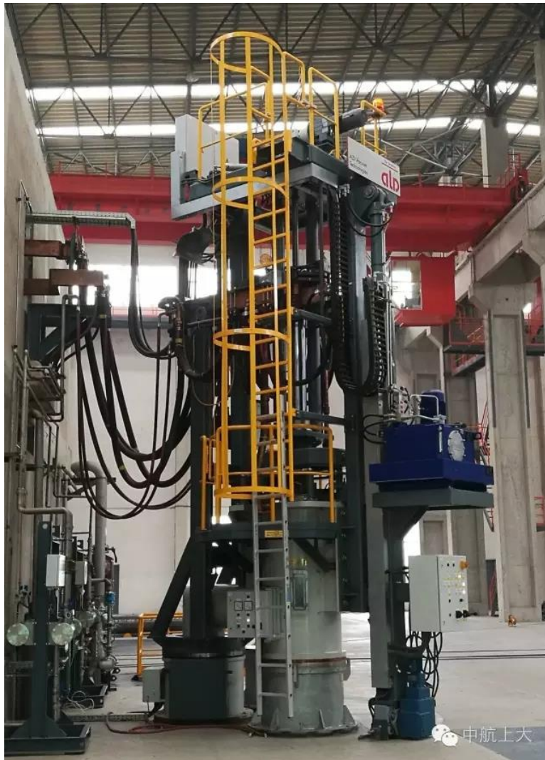
图表 147 中航上大引进 6t 真空自耗炉完成热负荷试车
