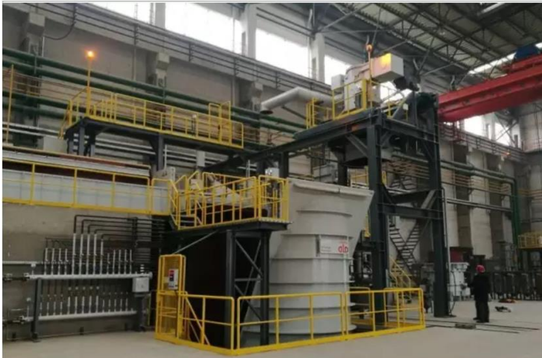
图表 146 中航上大引进德国 ALD 公司 6 吨真空感应炉
