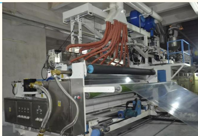
图表 28: 干法隔膜制造法-流延法
