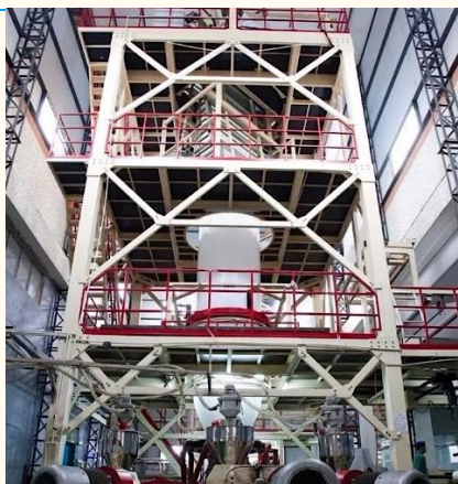
图表 27: 干法隔膜制造法-吹塑法
