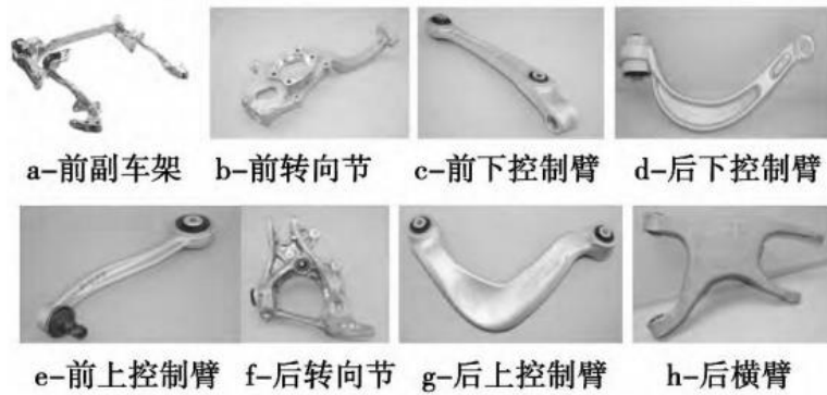
图11：锻造工艺目前主要应用于汽车底盘结构件
